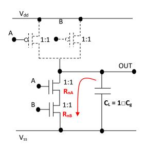
$tpHL = 2R_{sn}(1/1) * C_L$  $= 2R_{sn} * 1\Box C_g$  $= 2 \tau$
